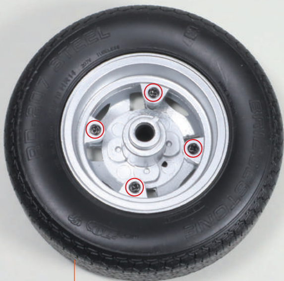
在第3期中組裝完成的左前輪背面
