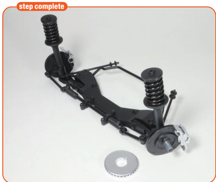
將 15-D 與 16-D 的螺絲孔對齊，使用 TM 螺絲 在兩個位置固定。
